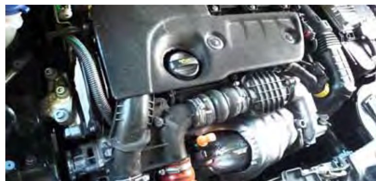
Do omezeného prostoru přední části vozu se podařilo vtěsnat naftový čtyřválec BlueHDi 100 likvidující složku NO x ve spalínách pomocí aditiva AdBlue
