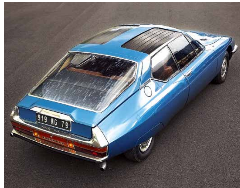
Luxusní, aerodynamické a extravagantní: Kupé SM vzniklo díky fúzi s Maserati. Poháněly jej výhradně V6, do výroby přineslo v Evropě dosud nevídané lepené čelní sklo nebo výškově i podélně nastavitelný volant.
