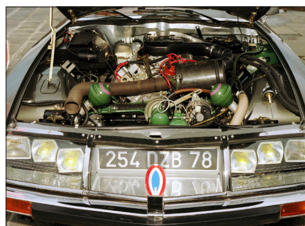
Šestiválec V6 s rozvodem DOHC objemu 2670 cm 3
