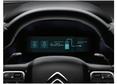
Digitální přístrojový 12,3", displej se zobrazením hybridního režimu
