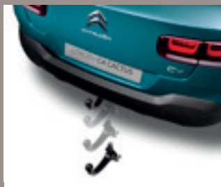
TAŽNÉ ZAŘÍZENÍ S KOULÍ DEMONTOVATELNÉ BEZ NÁŘADÍ
